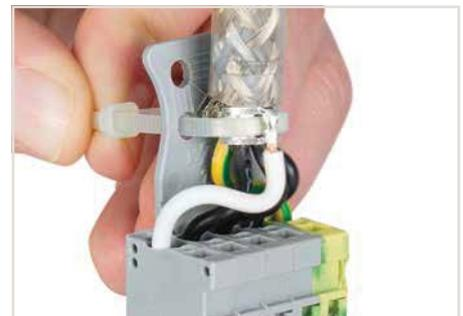
À l'aide des serre-câbles, fixer la tresse de blindage et le transfert de blindage à la plaque de décharge de traction.
