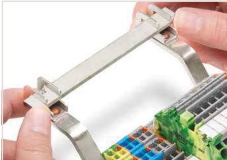
Placer la barre collectrice sur le support pour barres collectrices
