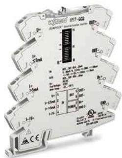
Amplificateur isolateur JUMPFLEX®, signal d'entrée de tension/courant, signal de sortie de tension/courant bipolaire, réglage du Zéro/Gain (Span), configuration par commutateur DIP, tension d'alimentation 24 V DC, largeur 6 mm
