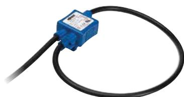
Boucle de mesure Rogowski, courant primaire 4000 A, signal de sortie 22,5 mV/1kA, diamètre bobine 125 mm
