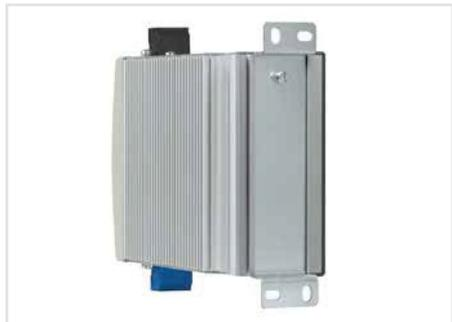
Adaptateur pour fixation murale, pour la fixation à vis des équipements 787-8xx sur une plaque de montage ou au mur, sans rail (DIN 35). L'adaptateur de montage murale remplace le support de rail monté au niveau de l'appareil 787-8xx. La fixation de l'adaptateur sur les équipements 787-8xx se réalise à l'aide d'une vis (fournie).
