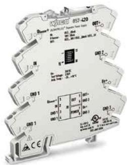
Amplificateur isolateur JUMPFLEX®, signal d'entrée de courant, signal de sortie de tension/courant, configuration par commutateur DIP, tension d'alimentation 24 V DC, largeur 6 mm
