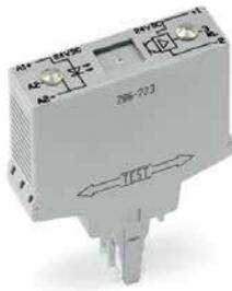
Module optocoupleur, plage de tension de sortie 20 ... 30 V DC, courant permanent limite 0,5 A, raccordement 3 conducteurs, à commutation positive, LED rouge, largeur 15 mm
