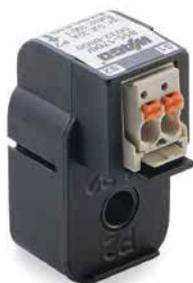
Transformateurs d'intensité compacts, courant primaire 32 A, courant secondaire 320 mA, puissance 0,01 VA, classe de précision 0,5
