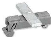
Support avec pied de mise à la terre, parallèle au rail, long. 45 mm, en cuivre 10 x 3 mm, pour étrier de blindage série 790 et bornes de raccordement de tresse de blindage série 791
