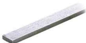
Barre collectrice, étamée, longueur 1000 mm, Cu 10 mm x 3 mm, I<sub>N</sub> 140 A
