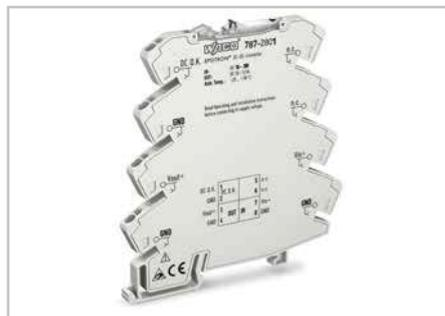
Les convertisseurs DC/DC, en boîtiers compacts de 6 mm ou en boîtiers de montage, encliquetable sur rail DIN 35 ; les convertisseurs DC/DC sont utilisés là où l'utilisation d'un module d'alimentation séparé avec tension spécifique n'est pas rentable, en raison des petites tensions, par ex. pour l'alimentation de capteurs, d'actionneurs, de participants au bus DALI etc.
