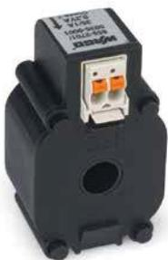
Transformateurs d'intensité compacts, courant primaire 35/64 A, courant secondaire 1 A, puissance 0,2 VA, classe de précision 1
