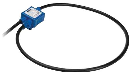
Boucle de mesure Rogowski, courant primaire 4000 A, signal de sortie 22,5 mV/1kA, diamètre bobine 175 mm
