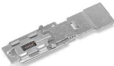
Adaptateur pour rails, pour la fixation des dispositifs 787-8xx sur rail (DIN 35). L'adaptateur pour rails (787-896) peut être utilisé pour un montage vertical ou horizontal des appareils 787-8xx. Fixer l'adaptateur pour rail réf. 787-896 au dispositif en insérant les deux éléments individuels dans les rainures de guidage du dissipateur puis visser. On peut ainsi facilement modifier la position.
