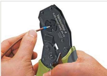
Introduire le conducteur muni de l'embout d'extrémité dans la pince de sertissage.
