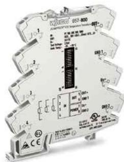
Convertisseur de mesure de température JUMPFLEX® pour capteurs Pt, signal de sortie de tension/courant, configuration par logiciel, tension d'alimentation 24 V DC, largeur 6 mm
