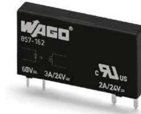
Relais statique miniature, plage de tension de sortie 0 ... 24 V DC, courant permanent limite 3 A, largeur 5 mm, hauteur 15 mm
