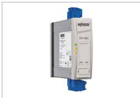
Avec leurs deux diodes de puissance intégrées, les modules de redondance permettent le branchement en parallèle de modules d'alimentation pour augmenter la disponibilité de l'alimentation ou pour augmenter le courant total pour les récepteurs 12, 24 ou 48 V DC.
