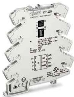
Amplificateur isolateur JUMPFLEX®, signal d'entrée de tension/courant bipolaire, signal de sortie de tension/courant bipolaire, réglage du Zéro/Gain (Span), configuration par commutateur DIP, tension d'alimentation 24 V DC, largeur 6 mm
