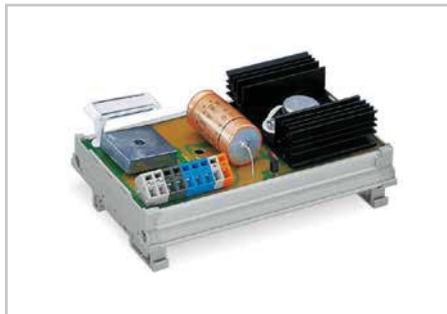
Alimentations en tension constante pour générer une tension stabilisée DC 24 V, avec régulateur de tension longitudinale intégré ; connexion rapide, résistante aux vibrations et aux chocs et sans entretien grâce à la technique de raccordement CAGE CLAMP® ; montage possible sur rail DIN 35.
