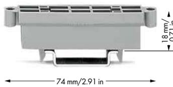
Barre collectrice pour contacts de pontage, pour rail DIN 35, adaptée au contact de pontage horizontal, série 279 à 284, fiches banane, série 215
