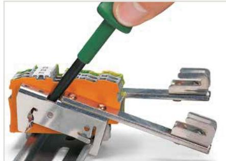
Démonter le support pour barres collectrices à l'aide d'un outil de manipulation type 3, lame (5,5 x 0,8) mm.
