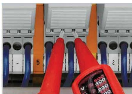
Tester le fonctionnement par simple contact protégé
