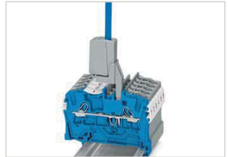
La fiche de test (2009-182) est appropriée pour les séries de 2000 à 2016 pour le raccordement sans outil des fils d'essai individuels jusqu'à 2,5 mm 2 .
