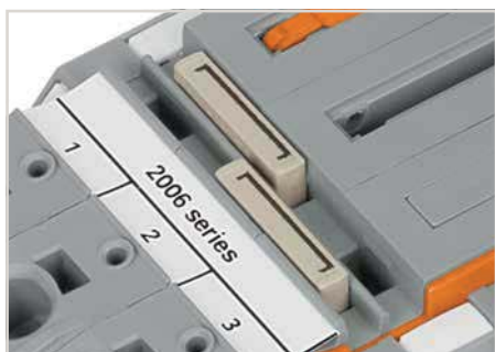
Pontage d'une borne au pas de 15 mm avec les peignes de pontage de 1 à 3 (2006-433) et de 1 à 5 (2006-435).
