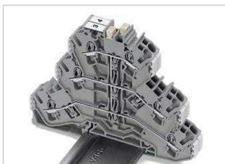
Le contact de pontage vertical à trois étages (2002-493) relie dans des bornes à trois étages trois niveaux entre eux.
