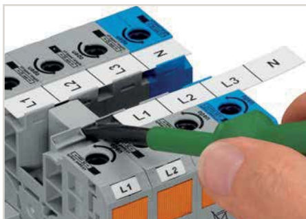
Pour démonter les contacts de pontage, il faut déplacer les bandes de repérage latéralement.
