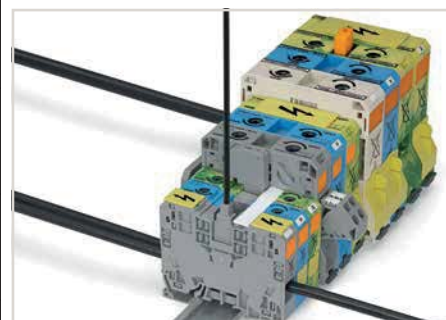
Le borne de prise de potentiel (283-407) doit être insérée dans la borne sur rail jusqu'à la butée !
