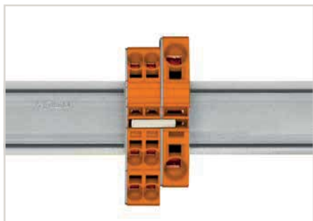
Contact de pontage réducteur (2006-499): de 6/4 mm 2 (séries 2006/2004) à 4/2,5/1,5 mm 2 (séries 2004/2002/2001)
