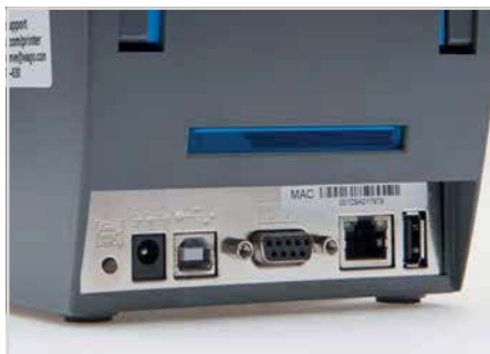
L'imprimante dispose de plusieurs interfaces : USB, ETHERNET, port COM série
