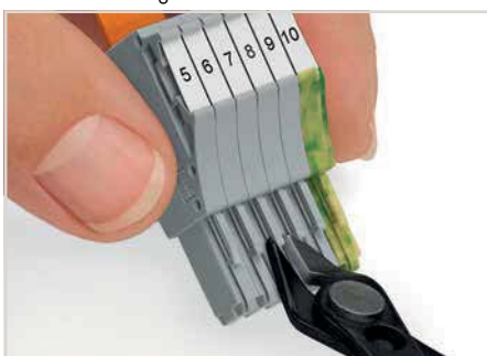
Codage des connecteurs femelles – séparer la tige de codage souhaitée du connecteur femelle à l'aide d'un outil approprié.
