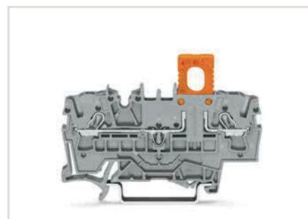
Séparateur (2002-401) enfiché dans dans une borne de base (2002-1661) en position de fonctionnement
