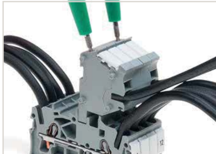
Les connecteurs TOPJOB®S disposent d'un trou de test (diamètre 2 mm) avec 2 pôles permettant de réaliser des tests de tension.
