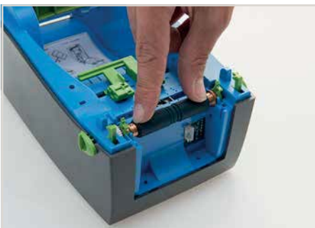
Placer et fixer le rouleau d'entraînement adapté dans l'imprimante
