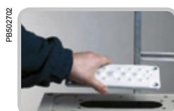
Installer la membrane dans un orifice standard en exerçant une légère pression.
