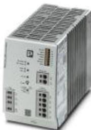
Alimentation sans interruption avec bloc d'alimentation intégré. Pour accumulateur d'énergie AGM plomb de capacité nominale 3,4 à 38 Ah. Entrée : triphasée, sortie : 24 V DC / 20 A. Connectique Push-in
