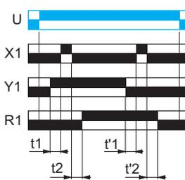
Après la mise sous tension et l'activation de la commande Y1, la temporisation T démarre et il est possible de l'interrompre/la suspendre à chaque fermeture de X1.
