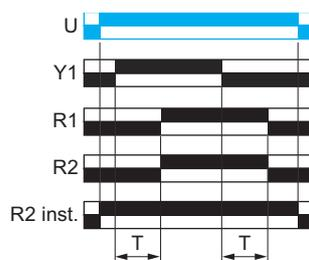
Après la mise sous tension et la fermeture de Y1, la temporisation T démarre.
