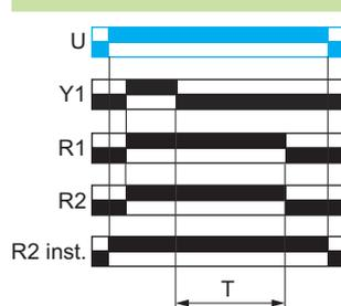
Après la mise sous tension et la fermeture de la commande Y1, la ou les sortie(s) R se ferme(nt).
