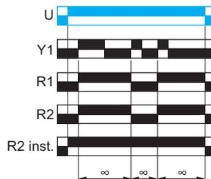
Après la mise sous tension et la fermeture de la commande Y1, la ou les sortie(s) R se ferme(nt). Du fait de la fermeture ultérieure de Y1, la ou les sortie(s) R revien(nen)t à son/leur état actuel.
