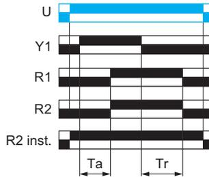
Après la mise sous tension et la fermeture de la commande Y1, la temporisation se met en marche pendant un temps Ta.
