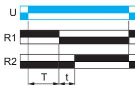
Après la mise sous tension, la sortie R1 est dans son état initial, entraînant la fermeture du contact "étoile" et du contact principal, et la temporisation T démarre (la temporisation du contact "étoile" démarre).
