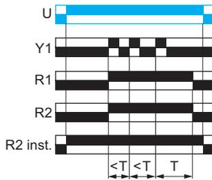
Après la mise sous tension et une première impulsion Y1, la ou les sortie(s) R se ferme(nt).
