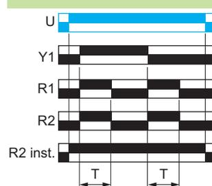
Après la mise sous tension, le changement d'état de Y1 (de l'état ouvert à l'état fermé, ou vice versa) entraîne la fermeture de la ou des sortie(s) R pendant la durée de la temporisation T suivie de leur réouverture.
