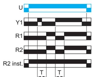
Après la mise sous tension, une impulsion ou un contact maintenu de Y1 lance la temporisation T.
