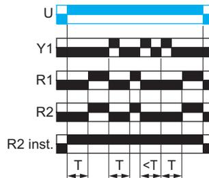
À la mise sous tension, une première temporisation T s'effectue. À la fin de cette temporisation, la ou les sortie(s) R se ferme(nt).
