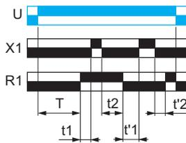
$$T = t_1 + t_2 + \dots$$
