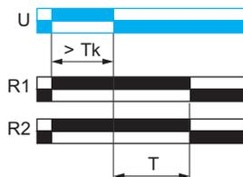
Après la mise sous tension, la ou les sortie(s) R se ferme(nt).
