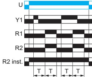
Après la mise sous tension, une impulsion ou un contact maintenu de la commande Y1 lance la temporisation T. Un cycle unique démarre alors avec 2 temps T de durée égale (départ avec sortie(s) R en position initiale).
