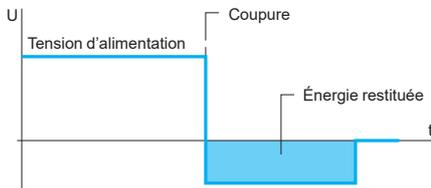
Tension de bobine avec module de protection à diode ( $\text{---}$  uniquement)
