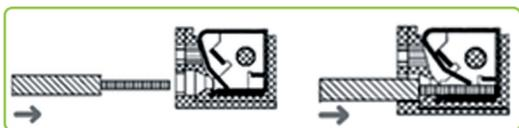
Borne à ressort "Push'n'Stay" : raccordement sans outil
