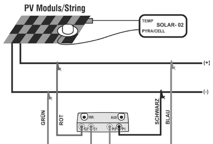
Abb 11: Anschluss des Messgerätes an den String
