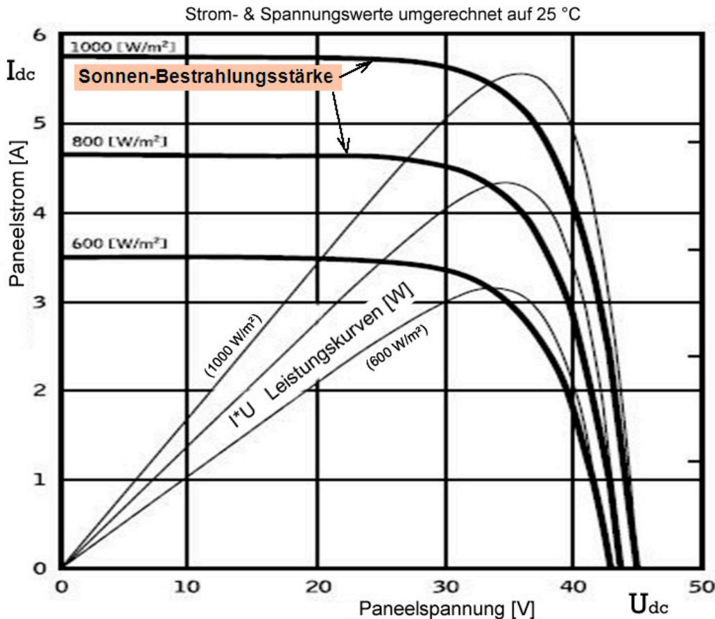
Wenn die Leistungsausbeute des Systems optimiert bzw. maximiert wird, macht sich die PV Anlage offensichtlich am schnellsten bezahlt, egal ob sie die Leistung ans allgemeine Stromversorgungsnetz liefert oder als autonome Benutzeranlage betrieben wird.
