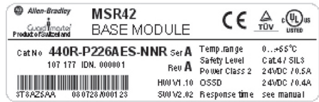
Figure 14 : Etiquette signalétique du module de base MSR42 avec configuration de base EDM
