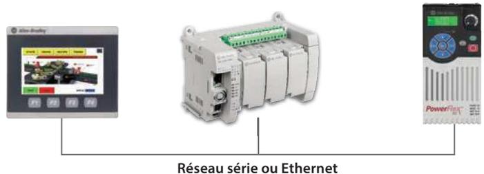
Optimisé pour une utilisation avec les automates Micro800 et MicroLogix.
