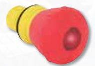
Bouton-poussoir d'arrêt d'urgence, lumineux, déverrouillage par rotation, 40 mm, type « coup de poing »
