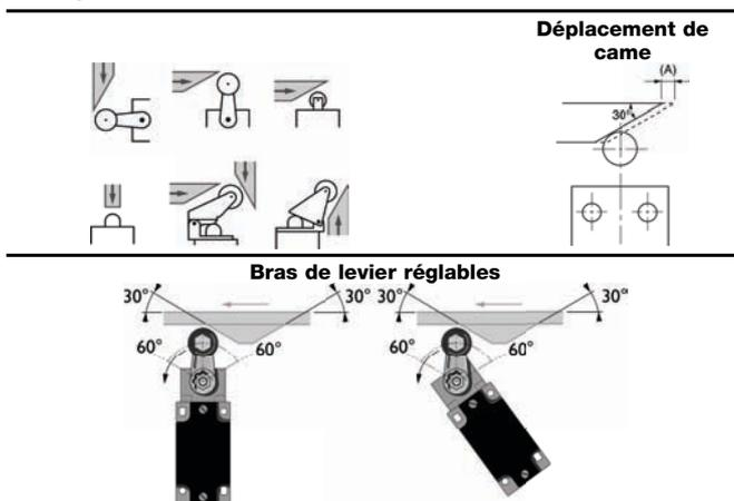
La came de déclenchement doit avoir une pente de 30 ° pour obtenir un fonctionnement optimal.
