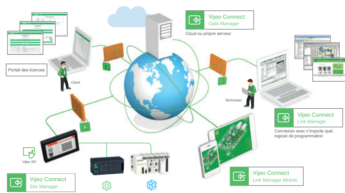
Vijeo Connect pour l'accès de programmation distant à l'IHM et à ses appareils connectés
