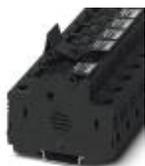
Bloc de jonction-fusibles, type de fusible: Verre / Céramique / ..., type de raccordement: Raccordement vissé, section : 1,5 mm<sup>2</sup>- 25 mm<sup>2</sup>, AWG: 16 - 3, intensité nominale: 30 A, tension nominale: 1000 V, largeur: 18 mm, type de fusible: 10,3 x 38 mm, type de montage: NS 35/7,5, NS 35/15, coloris: noir
