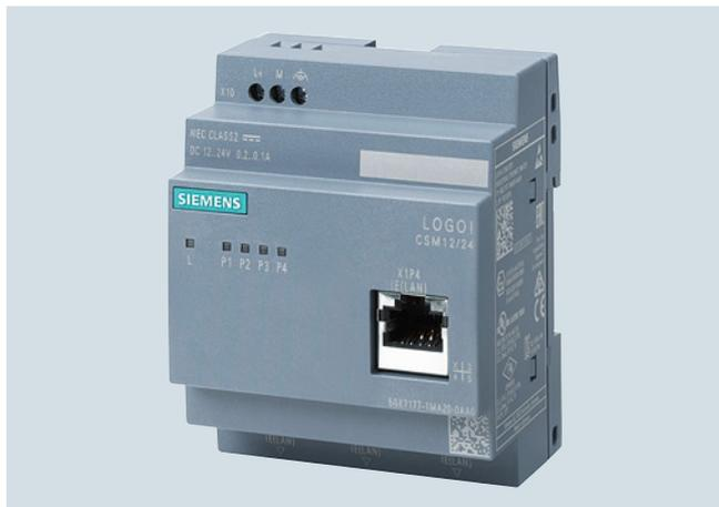
Le module sert au raccordement d'un LOGO! et de max. trois abonnés supplémentaires à un réseau Industrial Ethernet à 10/100 Mbit/s en topologie linéaire, arborescente ou en étoile.
