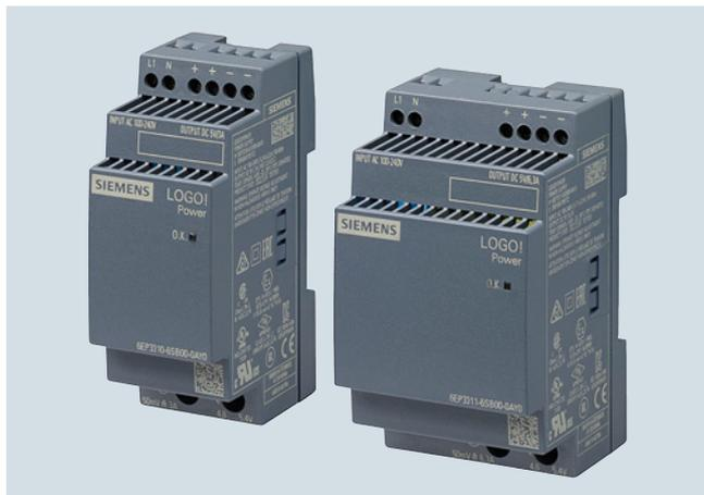
La ligne de produits LOGO!Power avec sa forme échelonnée convient tout particulièrement à une utilisation dans des coffrets de distribution d'installations. Les alimentations stabilisées avec entrée à large plage 100 ... 240 V CA (85 ... 264 V) ainsi que 110 ... 300 V CC sont disponibles en deux classes de puissance
