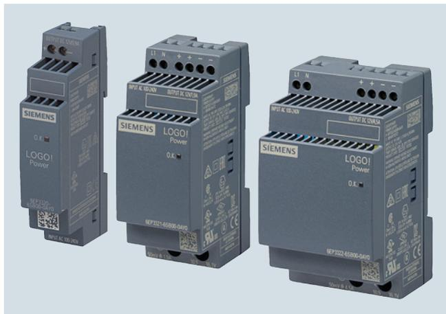
La ligne de produits LOGO!Power avec sa forme échelonnée convient tout particulièrement à une utilisation dans des coffrets de distribution d'installations. Les alimentations stabilisées avec entrée à large plage 100 ... 240 V CA (85 ... 264 V) ainsi que 110 ... 300 V CC sont disponibles en trois classes de puissance avec une tension de sortie de 12 V. La variante 12 V est idéale pour l'alimentation d'automates LOGO! avec la tension d'entrée
