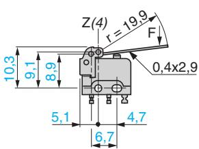
(1) Il est déconseillé de démonter le levier d'un produit complet, il y a risque de destruction des picots d'ancrage.
