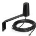
Antenne de téléphonie mobile multi-bande, avec équerre de montage pour une installation à l'extérieur, câble d'antenne de 5 m à connecteur rond SMA, adaptée pour LTE/4G
