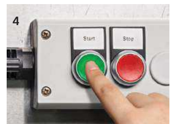
4 Mettre en marche. Le moteur fonctionne en vitesse variable.
